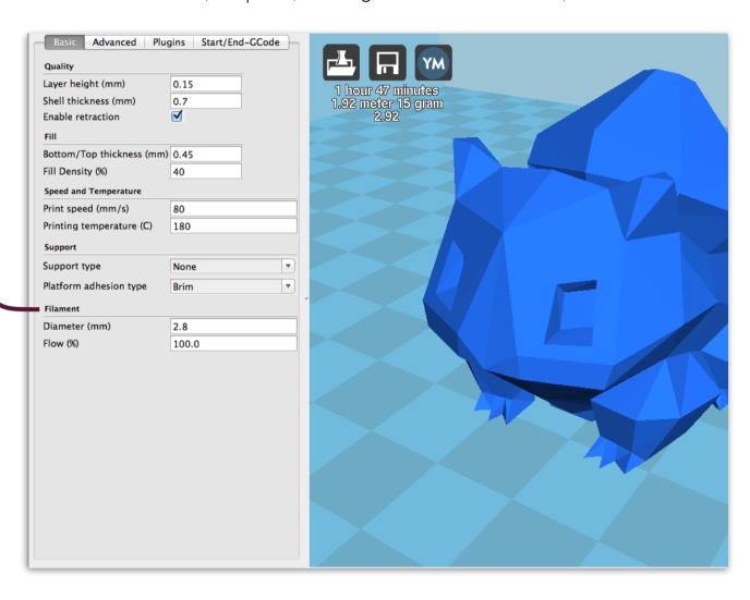
Flow rappresenta il flusso di materiale che viene estruso dall'ugello ed è determinato da quanto il motore dell'estrusore spinge il filo all'interno dell'hot end.
